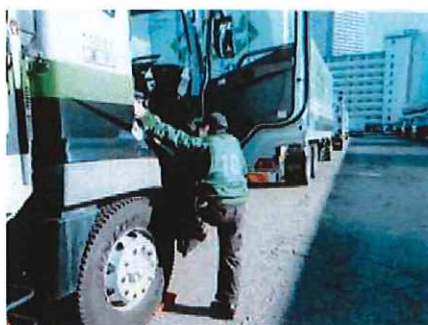
墜落・転落防止：三点支持の徹底
